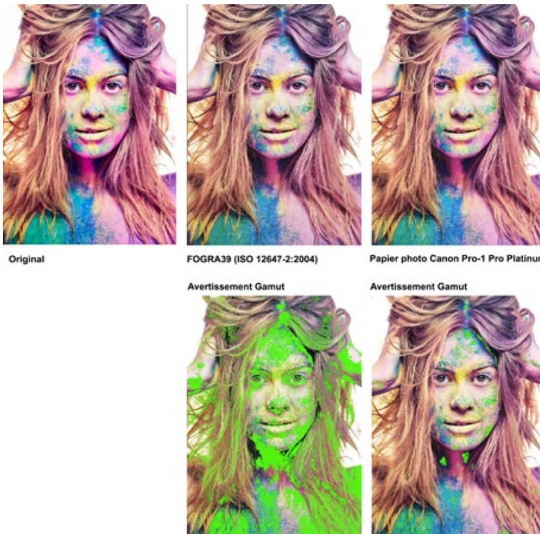
Nous comparons l'image originale avec deux épreuves dotées d'avertissements gamut. Le standard FOGRA39 (ISO 12647-2: 2004), très utilisé en impression offset, est ici sélectionné. Le second profil appartient à la Canon Pixma Pro1 sur papier Pro Platinum. Il s'agit d'une imprimante photo 12 couleurs. Clairement, l'imprimante Canon imprime bien plus de couleurs issues de l'espace colorimétrique AdobeRGB.
