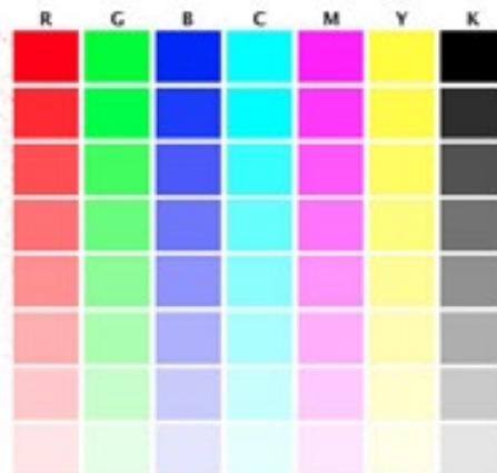
L'image ci-dessus illustre le résultat produit lorsque les jets d'encre fonctionnent mal, et impriment des couleurs dans des zones qui devraient être blanches. Bien qu'il soit utile de nettoyer une imprimante présentant ces symptômes, vous devrez probablement remplacer les têtes d'impression.
