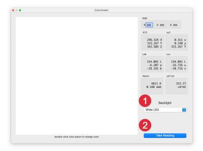
Utilisez la liste déroulante **Rétro-éclairage (1)** pour sélectionner la technologie de rétroéclairage correspondant à votre écran.
