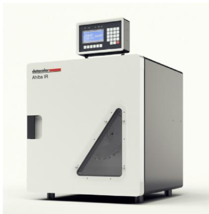
Les béchers ont un mouvement de rotation circulaire. Le chauffage infrarouge permet d'éliminer la contamination par le glycol et le nettoyage lourd des béchers qu'il entraîne. La pression offre une sécurité maximale et peut être utilisée pour les teintures haute et basse température. Les produits auxiliaires peuvent être facilement ajoutés grâce au couvercle spécialement développé à cet effet.
