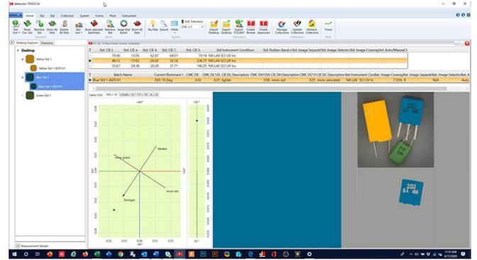
L'évaluation des couleurs à l'écran\* et la communication des données colorimétriques et des images haute résolution de l'échantillon améliorent l'efficacité et réduisent la nécessité d'expédier des échantillons physiques.
